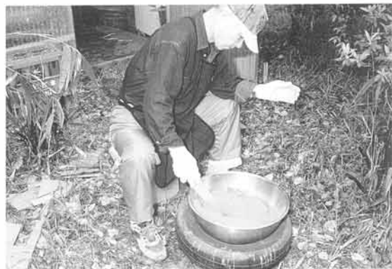
塗料の製作1 弁柄と丹土を混合する
