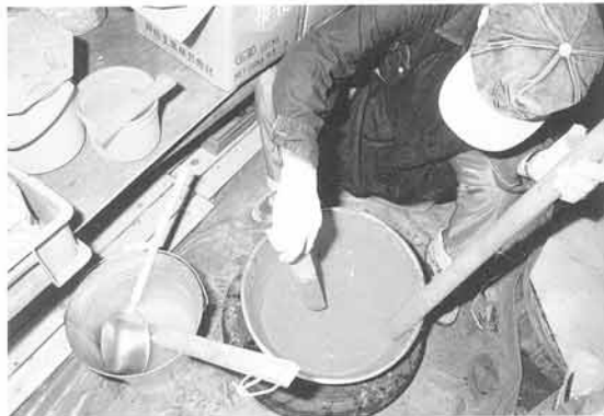
塗料の製作2 顔料と膠液を良く練り込む
