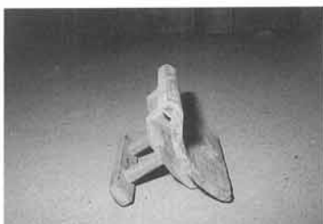
馬場瓦工業に残る丸棧の木型
