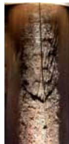
写11 斜光ライトによる痕跡確認(右)と記録
