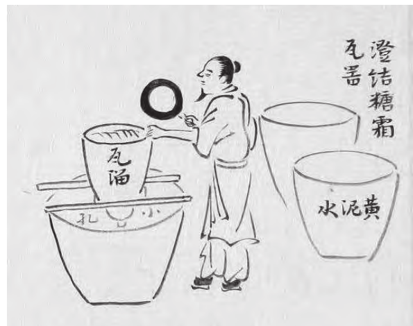
図56 糖漏使用法（天工開物より）
