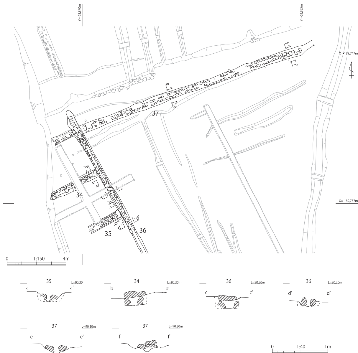
図10 34・35・36・37 暗渠 平面図・断面図
